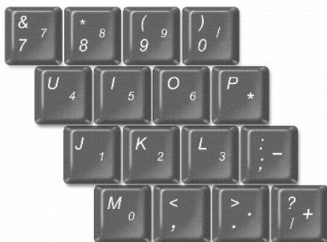
Встроенная цифровая клавиатура работает также как и внешняя цифровая клавиатура. Каждая клавиша выполняет несколько функций.
